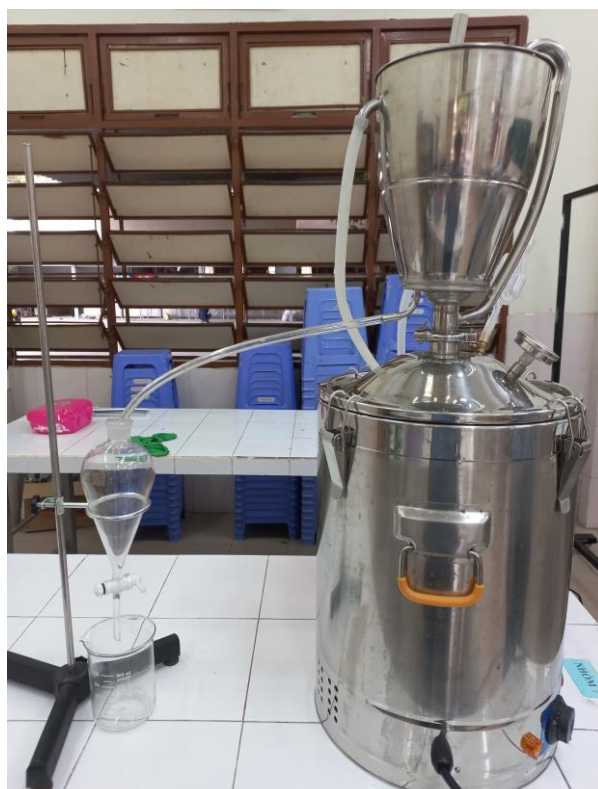
Hình ảnh về thí nghiệm chưng cất tinh dầu bằng phương pháp lôi cuốn hơi nước.
